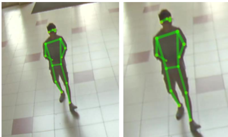
圖 20 用傳統 object detection 導致 scale 的誤差
