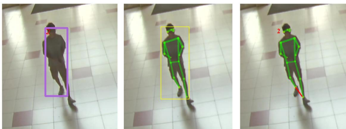
圖 19 從 tracking 結果回推腳踝座標
