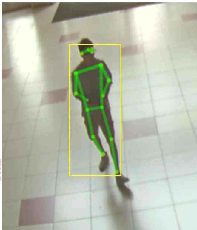
圖 17 從 Pose 算出行人 Bounding Box
